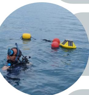
**2 de octubre:** Instalación de sonda multiparamétrica de bajo costo en el muelle de Isla Pérez con apoyo de personal de SEPASY y los permisos autorizados de CONANP. La sonda realiza monitoreo de parámetros fisicoquímicos del agua.
