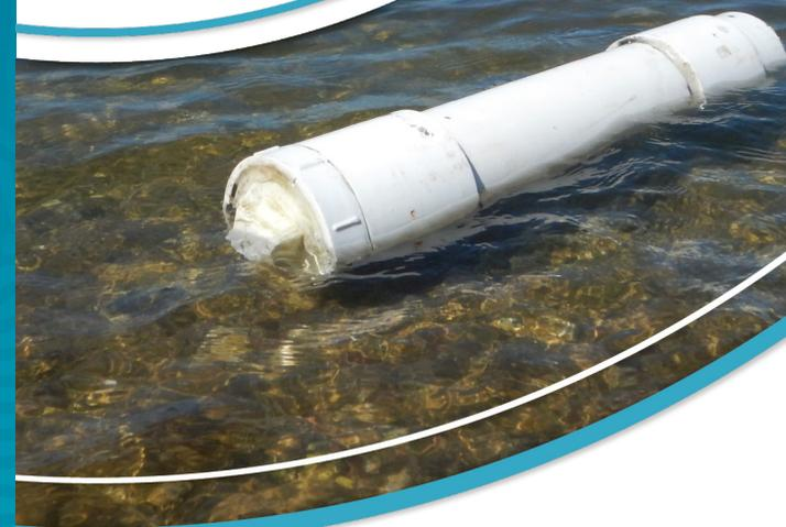
*Durante la más reciente década, el diseño y desarrollo de sondas de bajo costo ha resultado en una alternativa factible para el monitoreo continuo de parámetros fisicoquímicos como proxy para estimar las condiciones de calidad del agua. Su bajo precio competitivo, robustez, buena precisión, instalación relativamente fácil e integración con plataformas electrónicas de código abierto son una alternativa atractiva para el monitoreo ambiental (Mao et al., 2019; William, 2019).*
